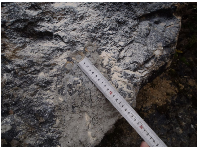
Tentative un peu gourmande, avec seulement 3 trous. La fissuration est fine, nette et profonde, merci les burins, ils ont bien travaillé.
