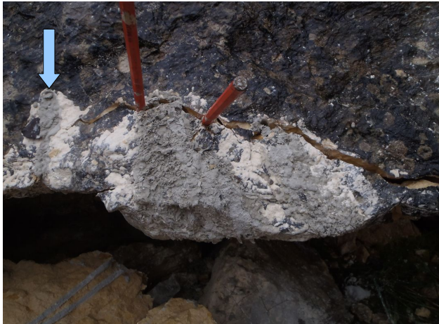
La flèche bleue indique un trou isolé, qui ne participe pas à la fissuration.
